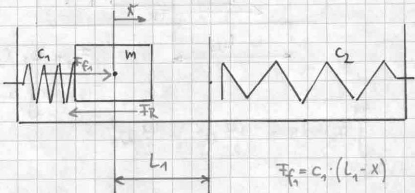
$$\int_{s_0}^{s_1} \bar{F}_s ds = \frac{m v_1^2}{2} - \frac{m v_0^2}{2}$$
