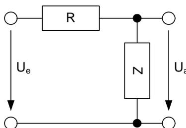
$$G(j\omega) := \frac{\left( \frac{1}{j\omega C + \frac{1}{j\omega L}} \right)}{R + \left( \frac{1}{j\omega C + \frac{1}{j\omega L}} \right)} \quad \text{Erweitern mit} \quad \frac{1}{j\omega C + \frac{1}{j\omega L}}$$
