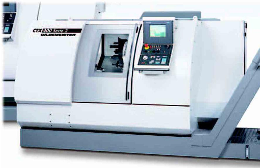
Bei modernen CNC-Drehmaschinen (Computer Numeric Control) wird heute jeder Bewegungseinheit ein eigener Antrieb zur Seite gestellt. Im Gegensatz dazu existierten früher Maschinen mit nur einem Motor und alle angetriebenen Teile wurden über gestufte Getriebe versorgt.
